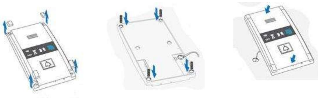
En el caso de que no tenga acceso a la pared de la cabina desde el lado exterior, realice el montaje utilizando los tornillos debajo del cristal con los pictogramas:
